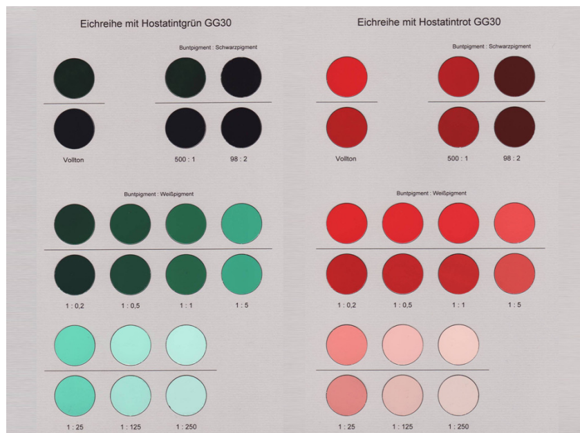
Abbildung 2: Auf Kontrastkarton über Schwarz und Weiß applizierte Eichreihenproben, auf mittelgrauen Karton aufgeklebt.
