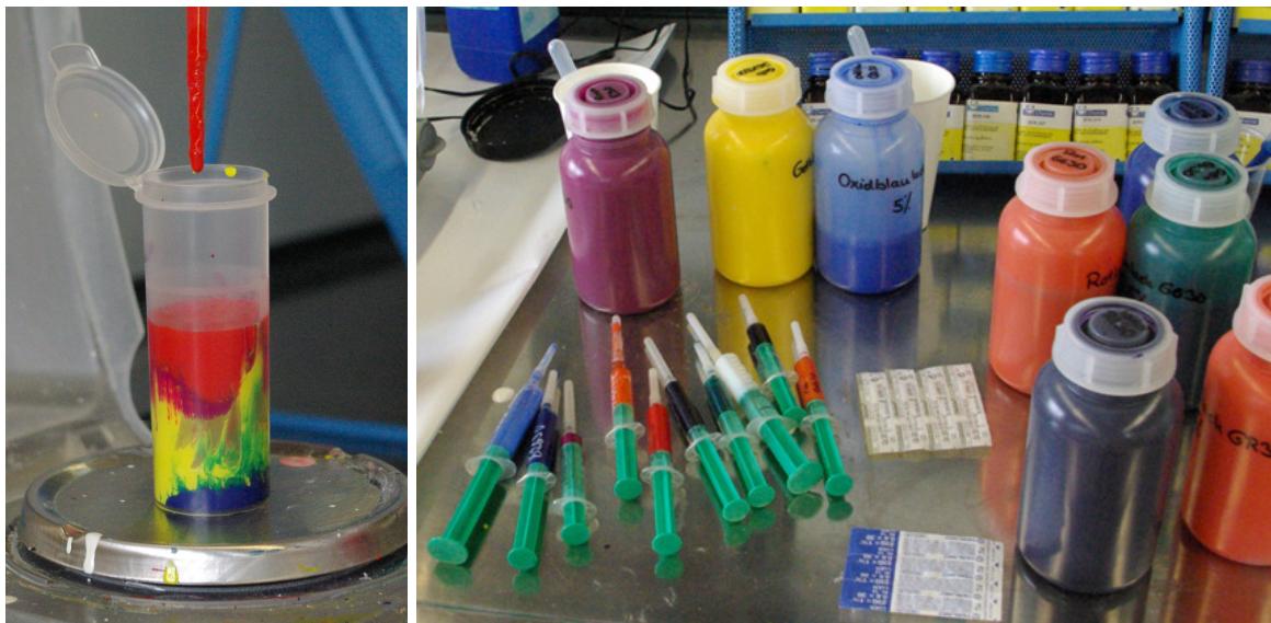
Abbildung 4: Bei der Ermischung der Rezepte dosierte man grob aus Pipetten und fein aus Spritzen.
